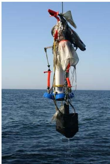
Abb.5 Bergung der beschädigten ADCP- Verankerung mit komplett zerstörten Auftriebs-elementen (Foto: T. Heene).
